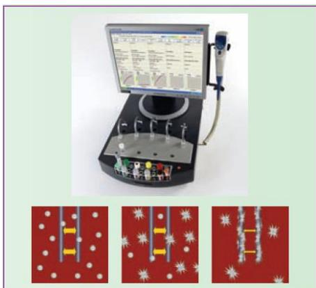
Изменение импеданса является мерой агрегации тромбоцитов в образце. При этом прибор автоматически устанавливает нулевой уровень, автоматически регистрирует скорость агрегации, ее максимум и проводит все вычисления. Для удобства сравнения данных и унификации результатов введены условные единицы AUC (площадь под агрегационной кривой). Все результаты, нормы и клинические рекомендации выдаются в этих единицах.
