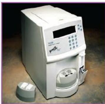
**стандартизованным аналогом теста на время кровотечения;** функциональный тест первичного гемостаза, который зависит от плазменного vWF и тромбоцитарных рецепторов GPIIb/IIIa и GPIb/ V/IX; глобальный тест, так как затрагивает практически все аспекты агрегации/адгезии тромбоцитов, межклеточные взаимодействия и плазменные факторы; имеется два вида картриджей – коллаген/ АДФ и коллаген/эпинефрин, которые позволяют определять
